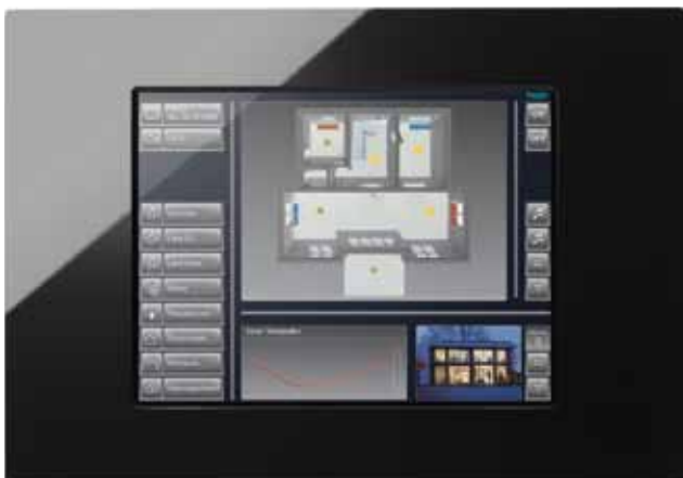
KNX Visualisierung der Innenraumtemperatur / KNX visualisation of the indoor temperature
